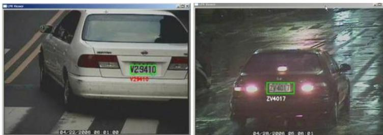
FIGURA 1 - Detecção de placa veicular através do software License Plate Recognizer.
