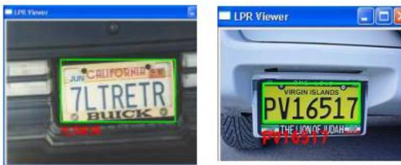
FIGURA 2 - Detecção de placa veicular através do software License Plate Recognizer. Detalhe de numeração da placa veicular.
