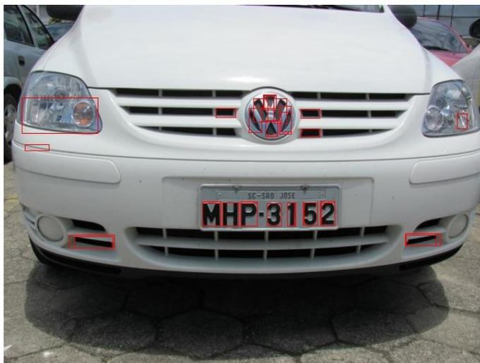
FIGURA 33 - Verificação dos caracteres: imagem original com os *BBs* após o processo de verificação dos *BBs* na *Beagleboard*.
