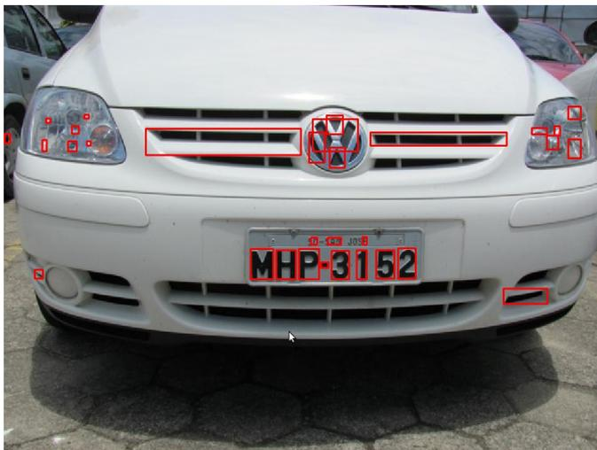
FIGURA 32 - Verificação dos caracteres: imagem original com os BBs após o processo de verificação dos *BBs* no *Matlab*.
